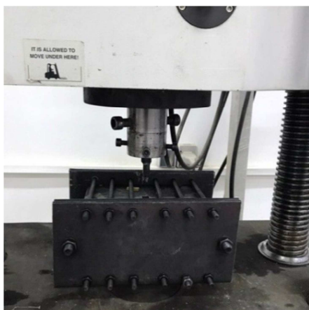
شکل ۵- نحوه استقرار قالب زیر دستگاه پرس
