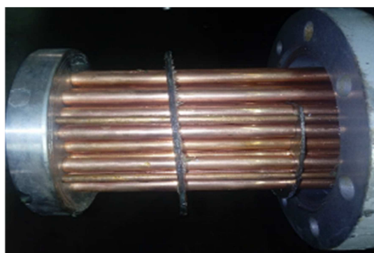
شکل ۵ - طرحواره اجزای داخلی مبادله‌کن گرمایی
