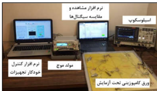
شکل ۴- پیکربندی سامانه پایش سلامت سازه‌ای اجرا شده
