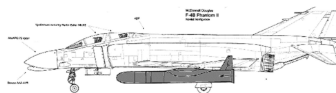
شکل ۱- طرحواره هواپیمای F-4 و موشک ماهواره‌بر هواپایه
