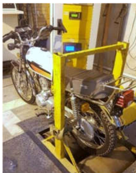
شکل ۷- نحوه استقرار موتورسیکلت بر روی شاسی دینامومتر
