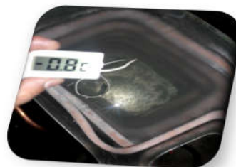
شکل ۸- مراحل یخ زدگی دور کویل محفظه مخزن یخ
