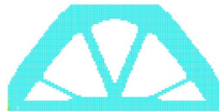
شکل ۶- توپولوژی بهینه برای اعمال بارها در زمان مختلف و استفاده از ضرایب وزنی بر اساس قابلیت اطمینان
