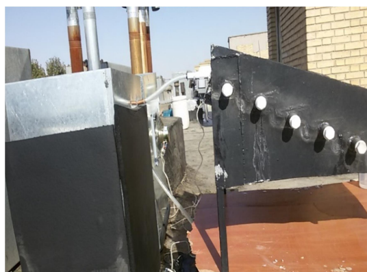
شکل ۴- آب شیرین کن خورشیدی پلکانی همراه با چگالنده و مواد تغییر فاز دهنده
