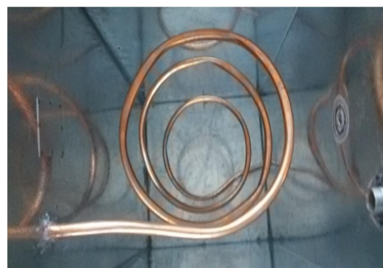
شکل ۵- لوله مسی ۱۶ میلی متری داخل چگالنده
