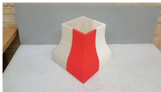
شکل ۵- نازل ساخته شده با استفاده از پرینتر سه‌بعدی
