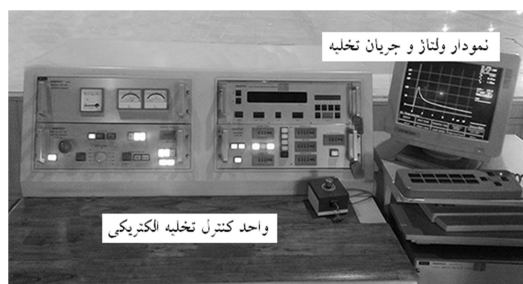
شکل ۲- تجهیزات فرایند شکل‌دهی الکتروهیدرولیکی
