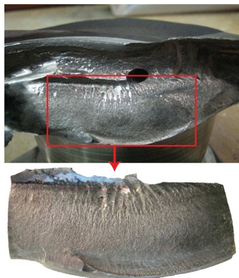
شکل ۴- سطح شکست ژورنال متحرک و قسمت بریده شده از آن جهت بررسی با SEM
