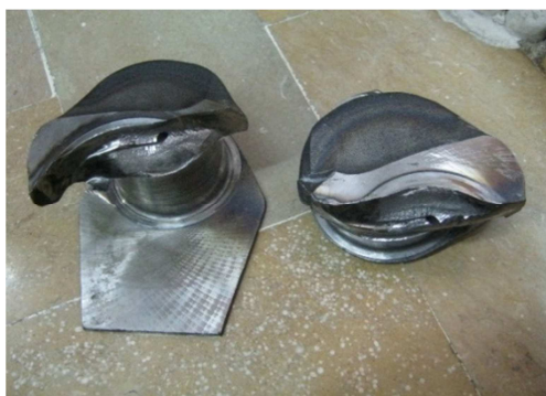
شکل ۲- تصویر قسمت های شکسته میل لنگ، ژورنال ثابت (تصویر سمت راست) و ژورنال متحرک (تصویر سمت چپ)
