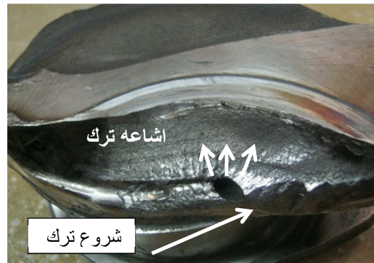
شکل ۳- سطح شکست ژورنال ثابت
