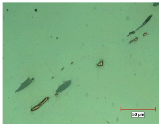
شکل ۵- ذرات سولفیدی و نیتربیدی در مقطع موازی پس از پولیش
