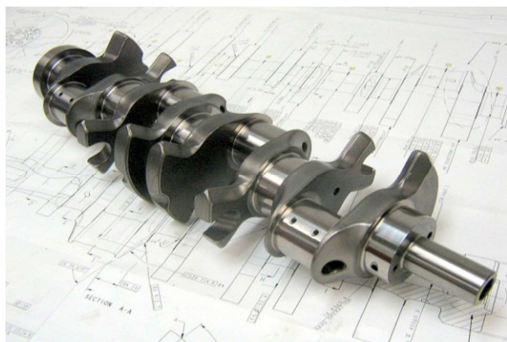
شکل ۱- تصویر میل لنگ سالم
