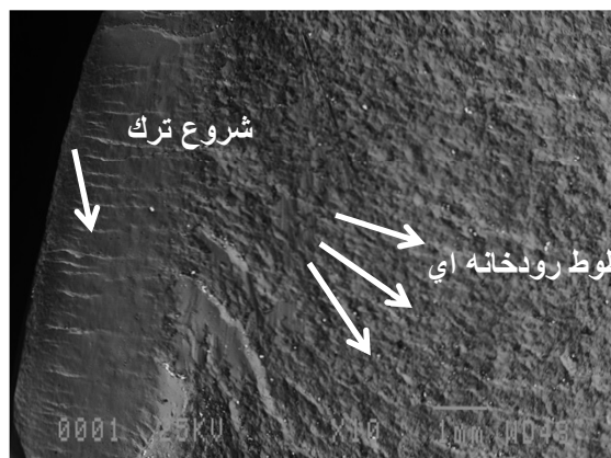
شکل ۱۰- ترک‌های شرع شده از سطح و خطوط رودخانه‌ای
