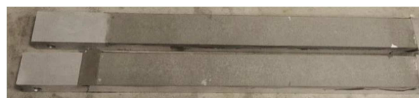
شکل ۸ - سطوح شکست نمونه DCB
