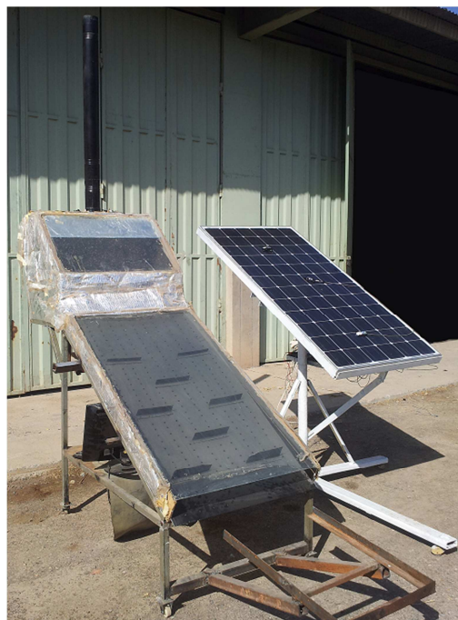
شکل ۱- تصویر خشک کن و پنل فتوولتائیک استفاده شده در تحقیق حاضر
