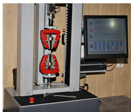
شکل ۳ - دستگاه تست کشش یونیورسال هیدرولیک GT-7001-LC
