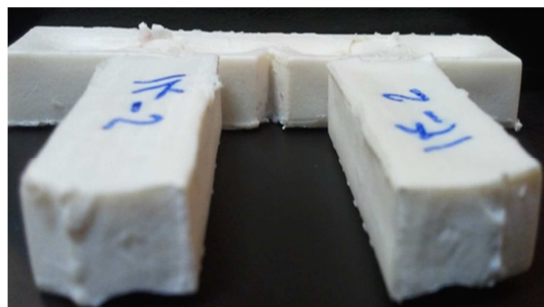
شکل ۲- یک نمونه قبل و بعد از آزمون ضربه
