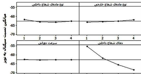
شکل ۱۳- نسبت سیگنال به نویز برای سطوح نوع ماده در شعاع داخلی و خارجی، سرعت دورانی و دمای شعاع داخلی در شرط مرزی گرمایی (ب)
