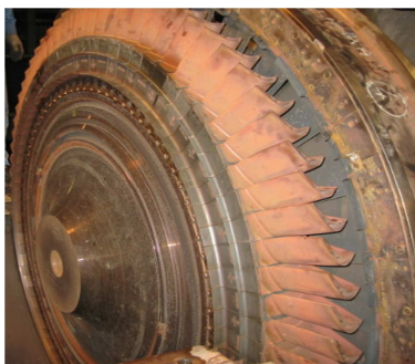
شکل ۳- پره مدل شده از روی پره توربین نئوپنیون ایستگاه تقویت فشار گاز فراشبند
