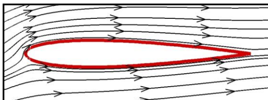
شکل ۱۶- اثرات هوا در جدایش جریان حالت دمشی ۰ (inj0)
