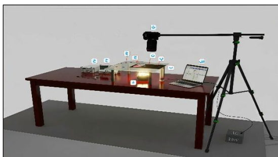
شکل ۳- شماتیک چیدمان آزمایش: الف) لب‌تاپ، ب) ظرف برای جمع‌آوری مایع مصرفی، پ) میکسر Y شکل، ت) قطرات فلز مایع جیوه، ث) دوربین دیجیتال، ج) مخازن ورودی پر شده با محلول هیدروکسید سدیم با غلظت ۰/۳ مول بر لیتر، چ) سیم مسی، ح) اسیلوسکوپ، خ) مولد سیگنال، د) منبع نوری
