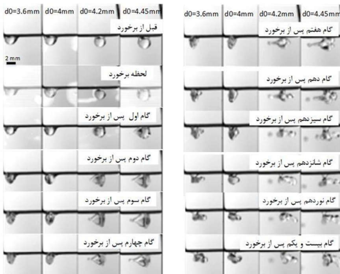
شکل ۵- گامهای مختلف تعامل قطره با موج ضربه با عدد ماخ ۰/۰۶. تعامل موج ضربه برخوردکننده از سمت راست به قطره. دو ستون سمت راست مربوط به قطره آب و دو ستون سمت چپ قطره گازوئیل می‌باشد. گامهای متوالی پس از برخورد موج ضربه. Oh_{D-3.6} = We_{D-3.6} = 192.87 و Oh_{W-4.45} = We_{W-4.45} = 82.78 و Oh_{W-4.2} = 0.0018 و We_{W-4.2} = 78.13 و Oh_{D-4} = 0.0139 و We_{D-4} = 214.3 و 0.0146 و 0.0018
