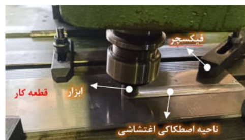
شکل ۲- فرایند اصطکاکی-اغتشاشی بر روی نمونه آلومینیوم آلیاژی ۶۰۶۱ در سرعت چرخش ابزار ۱۲۵۰ دور بر دقیقه، سرعت پیشروی ابزار ۳۰ میلی‌متر بر دقیقه و زاویه ابزار نسبت به سطح قطعه کار ۳ درجه.
