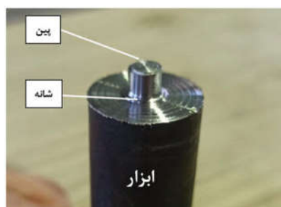
شکل ۱- ابزار فرایند اصطکاکی-اغتشاشی مورد استفاده در این تحقیق؛ ماده اولیه ابزار از جنس فولاد H13 به قطر ۲۰ میلی‌متر، قطر شانه ۲۰ میلی‌متر، قطر پین ۵ میلی‌متر و ارتفاع پین ۴/۵ میلی‌متر می‌باشد.
