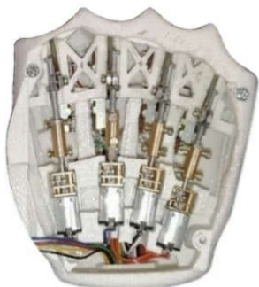
شکل ۵- اتصال موتورهای DC به دست ربات از نمای روبه رو
