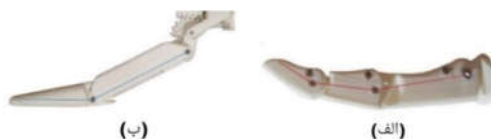
شکل ۳- طرحواره ای از مفاصل انگشتان دست ربات: (الف) انگشت اشاره و (ب) انگشت شست
