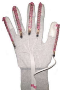
شکل ۹- دستکش مبتنی بر حسگر فلکس
