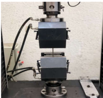
شکل ۵- نمایی از آزمون کشش نمونه دمبلی تهیه شده از آلومینیوم آلیاژی ۶۰۶۱.
