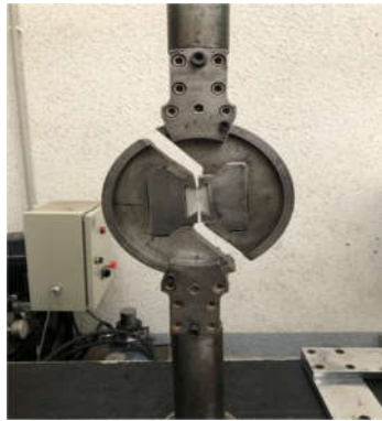
شکل ۸- آزمون تجربی شکست نمونه پروانه‌ای تحت مود II خالص برای نمونه‌های اولیه و فرآوری شده به روش اصطکاکی-اغتشاشی.
