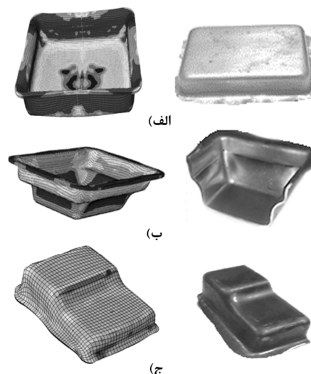
شکل ۱۹- قطعه نهایی شکل داده شده با ورق اولیه بهینه، الف) قطعه ساده در فشار ۲۴ مگاپاسکال، ب) قطعه وسط پله در فشار ۳۰ مگاپاسکال و ج) قطعه کنار پله در فشار ۴۰ مگاپاسکال، بدست آمده از تست تجربی و شبیه سازی
