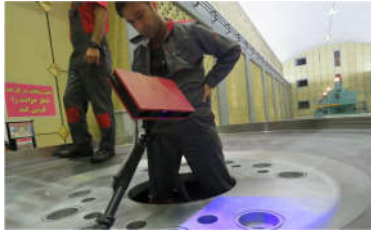
شکل ۳- اسکن‌گیری سه‌بعدی از چرخ
