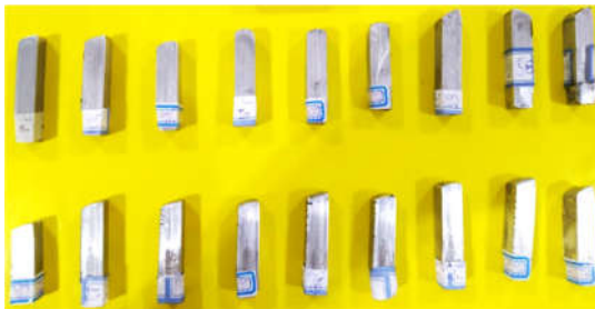
شکل ۴- نمونه های ساخته شده با فرآیند ECAP با طرح جدید قالب
