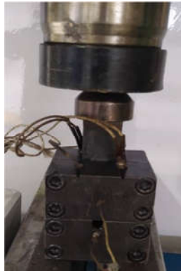
شکل ۳- فرآیند ECAP با استفاده از قالب با طراحی جدید
