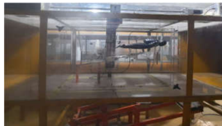
شکل ۸- الف: تونل باد مورد استفاده ب: نصب مدل در تونل باد
