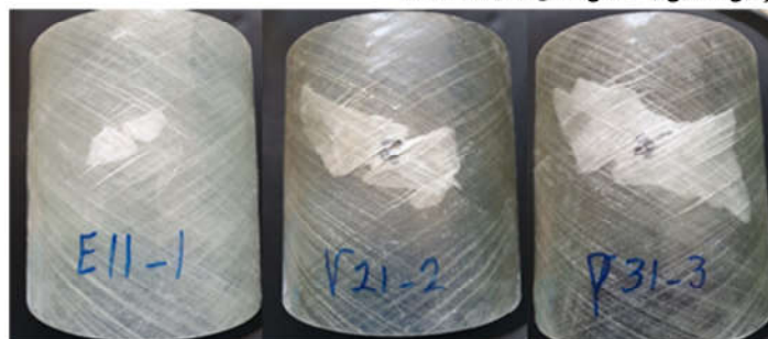
اپوکسی- ۱۰ ژول E11-1 ونیل استر- ۲۰ ژول V21-2 پلی استر- ۳۰ ژول P31-3 (الف)
