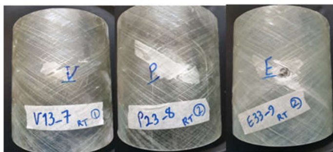
ونیل استر- ۱۰ ژول V13-7 RT ① پلی استر- ۲۰ ژول P23-8 RT ② اپوکسی- ۳۰ ژول E33-9 RT ③ (ب)
