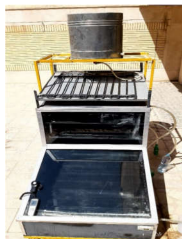
شکل ۲- آب شیرین کن خورشیدی پلکانی تحت آزمایش
