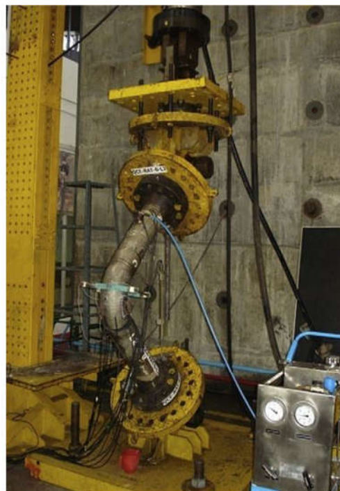
شکل ۱۲- آزمایش تجربی نمونه زانویی شکل [۱۴]
