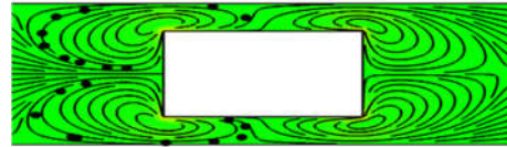
شکل ۷- به دام افتادن ذرات در گردابه‌های ایجاد شده (قطر ذرات، قطر واقعی نیست و بزرگنمایی شده است).
