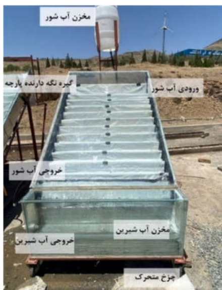
شکل ۱- تصویر دستگاه آب شیرین‌کن ساخته شده
