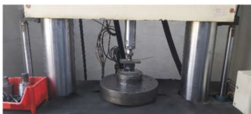
شکل ۶- آزمایش سنجش سفتی و میرایی میراگر با دستگاه تست دینامیک هارمونیک
