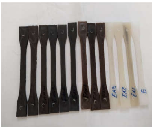
شکل ۱- نمونه‌های کامپوزیتی تولید شده برای انجام آزمون کشش
