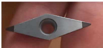
شکل ۳- ابزار CBN تراشکاری و کد ابزار VCGT 160404 CBN
