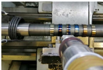
شکل ۴- تراشکاری ترکیبی به کمک حرارت دهی و ارتعاش فراصوتی
