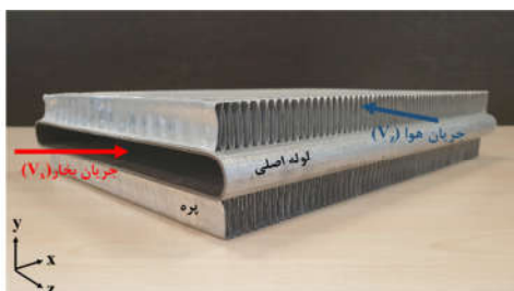
شکل ۱- نمای از دسته‌لوله‌های تک ردیفه چگالنده هوایی
