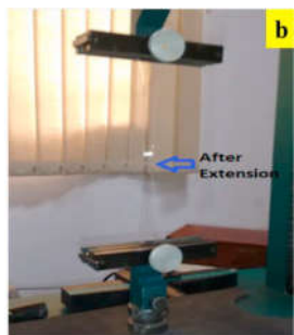
شکل ۴- تست کشش تک‌محوره الاستومر دی‌الکتریک (الف) قبل از کشش (ب) بعد از کشش
