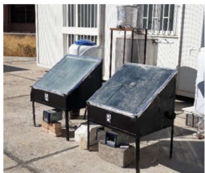
شکل ۹- نمایی از سیستم‌های آزمایشگاهی و اشباع شدن سیستم آزمایشگاهی A با بخار سرد در هنگام آزمایش
