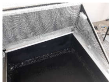
شکل ۶- نمایی از محل قرارگیری توری‌های فلزی در اطراف دیوار-ه‌های داخلی
