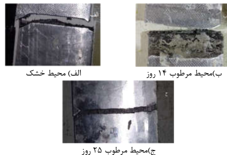
شکل ۶- شکست قطعه کامپوزیت الیاف-فلز در شرایط مختلف (الف) محیط خشک (ب) محیط مرطوب ۱۴ روز (ج) محیط مرطوب ۲۵ روز
