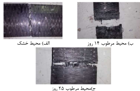
شکل ۴- شکست قطعه کامپوزیت کربن در شرایط مختلف (الف) محیط خشک (ب) محیط مرطوب ۱۴ روز (ج) محیط مرطوب ۲۵ روز
