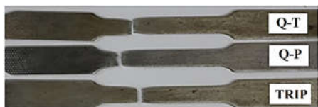
شکل ۶- نمونه های مورد پژوهش پس از انجام تست کشش
