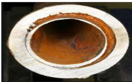
شکل ۵- نمونه‌ای از خوردگی ناشی از اسید سولفوریک [۱۵]
