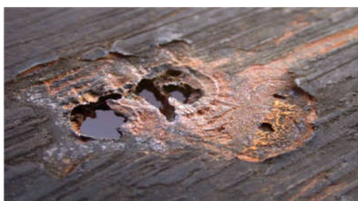
شکل ۳- نمونه‌ای از خوردگی حفره‌ای [۱۲]
