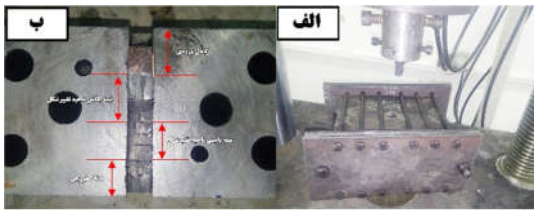
شکل ۱- الف) نمونه ساخته شده با روش سینترینگ پلاسمای جرقه‌ای (ب) نمونه جدا شده از قطعه اول با دستگاه برش سیمی
