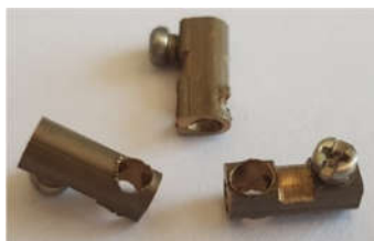
شکل ۲- ترمینال‌های سوراخکاری شده بعنوان بست سیم‌ها
