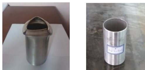
شکل ۵- لوله آلومینیومی s2: الف) قبل از آزمایش ب) بعد از آزمایش
