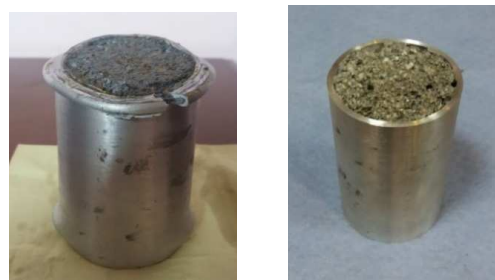
شکل ۵- لوله آلومینیومی s2: الف) قبل از آزمایش ب) بعد از آزمایش
