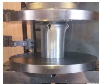
شکل ۴- نحوه‌ی قرارگیری نمونه بین صفحات تخت
