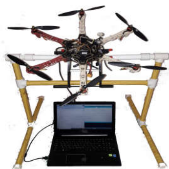
شکل ۹- سیستم آزمایشگاهی (میز کار درجه آزادی مولتی روتور)
