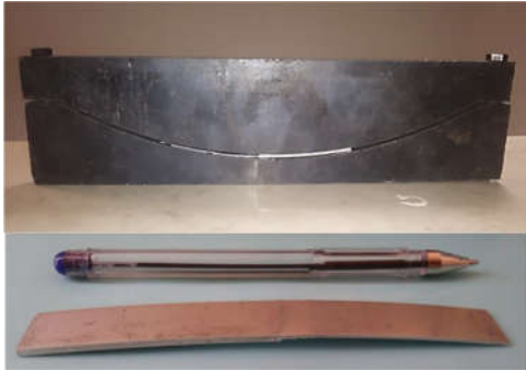
شکل ۲- مجموعه قالب شکل‌دهی خزشی و نمونه ای از ورق‌های ترکیبی ماشینکاری شده که توسط فرآیند شکل‌دهی خزشی تولید شده
