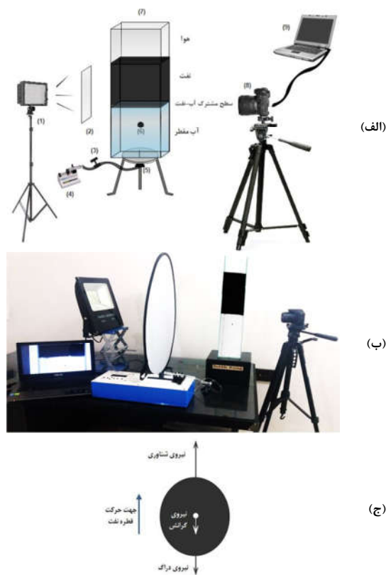
شکل ۱- مجموعه آزمایشگاهی، (الف) به صورت طر حواره، ۱: لامپ LED، ۲: دوربین، ۳: شیر یک طرفه، ۴: پمپ سرنگی، ۵: نازل سامانه، ۶: قطره نفت در حال صعود در ستون مایع آب-نفت، ۷: ستون حاوی مایع، ۸: دوربین، ۹: سامانه پردازش تصویر؛ (ب) تصویر واقعی مجموعه؛ (ج) نمایش برداری نیروهای وارد بر قطره ی در حال صعود
