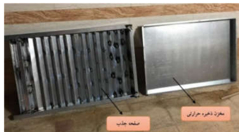
شکل ۱- نمای از مخزن ذخیره گرمایی و صفحه جذب
