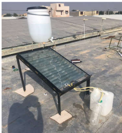
شکل ۳- تصویری از دستگاه آب شیرین کن پلکانی ساخته شده
