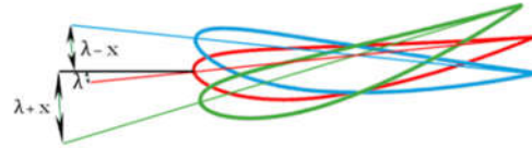
شکل ۸- چگونگی تغییر زاویه نصب در پره‌های توربین
