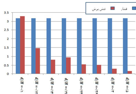
شکل ۱۳- سهم تنش برشی و فشار بر حسب فاصله مرکز ذرات از دیواره پایینی، \frac{d}{H} برای ذرات با قطر 3.9/7 میکرومتر
